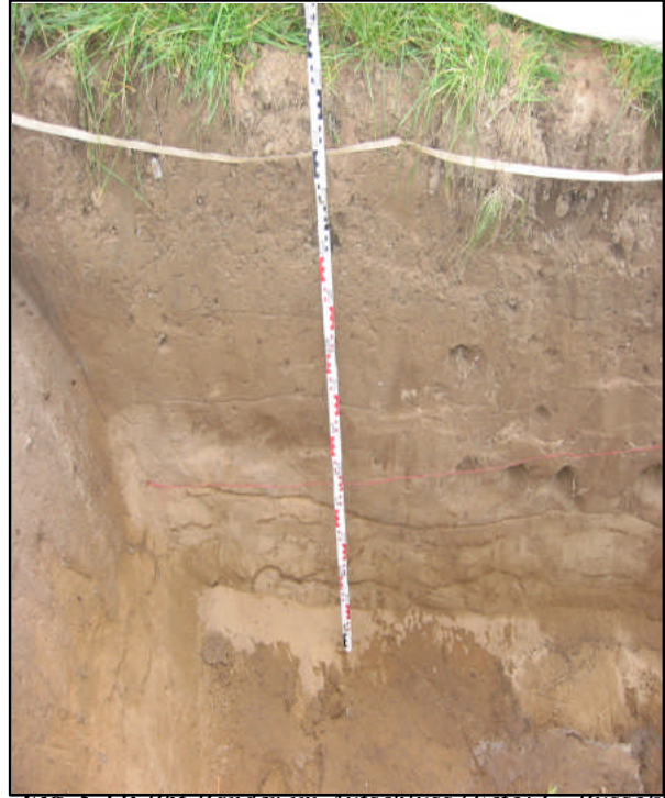
Fig. 5.22: BBI-Bänder im Aufschluss (Foto: C. Rüssok)
