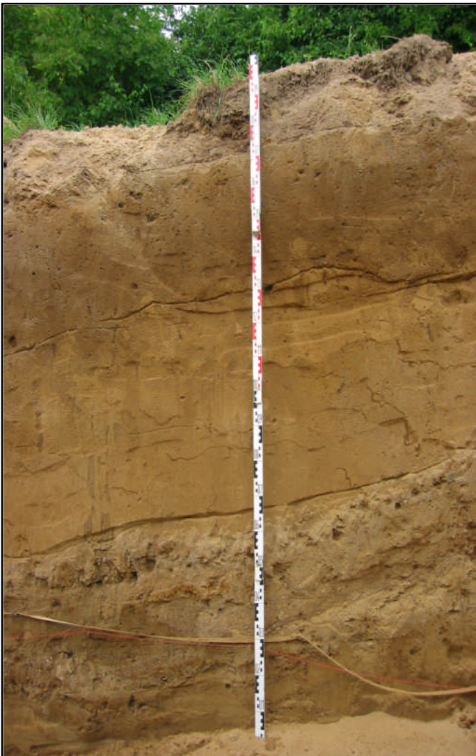
Fig. 3.10: Glazifluviale Prozessdynamik bedingt kleinräumigen Substratwechsel (Foto: C. Russok)
