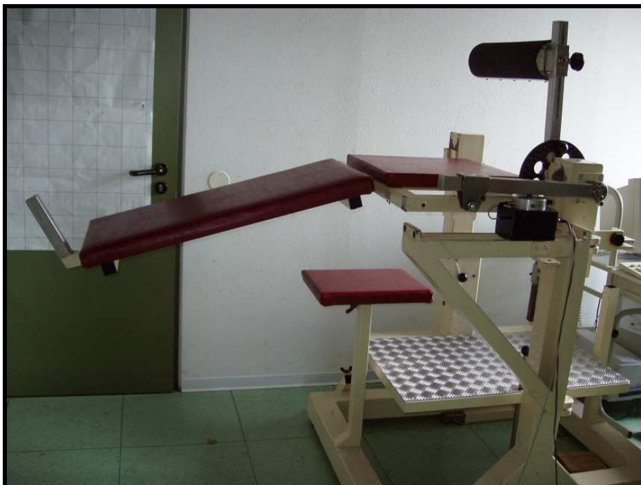
Abb. 46: der Kraftmessstuhl in der Beinbeugeposition
