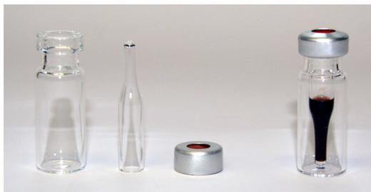
**Abbildung 1.1:** Probenlagerung kleiner Probenvolumina in einem Bördelrand-Gläschen. Links: 2 ml Bördelrand-Gläschen mit konischem Glaseinsatz und Aluminium-Bördelrand-Deckel mit PTFE/Neopren-Septum. Rechts: zusammengesetztes Probenlagerungsgläschen mit 100  $\mu\text{l}$  Probe.
