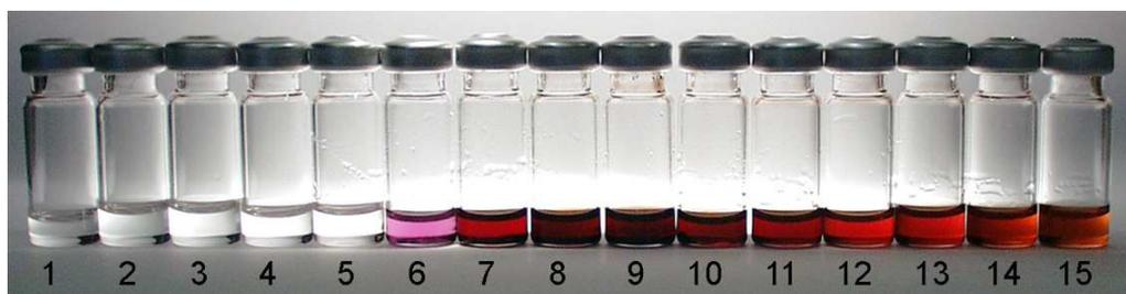
**Abbildung 10.2:** Photographie der gesammelten Extraktionen innerhalb der ersten 15 min nach Injektion von 2 ml Fullerenprobe mit endohedralen Europiumfullerenen in Toluol (Trennbedingungen: Hypercarb  $4,6 \times 50$  mm, 303 K, 0,5 ml/min Toluol; 1 bis 15 = Auszug der gesammelten Fraktionen).
