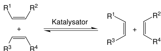
Abb. 1-14: Prinzip der Olefinmetathese. Es werden Doppelbindungen gespalten und neue gebildet.
