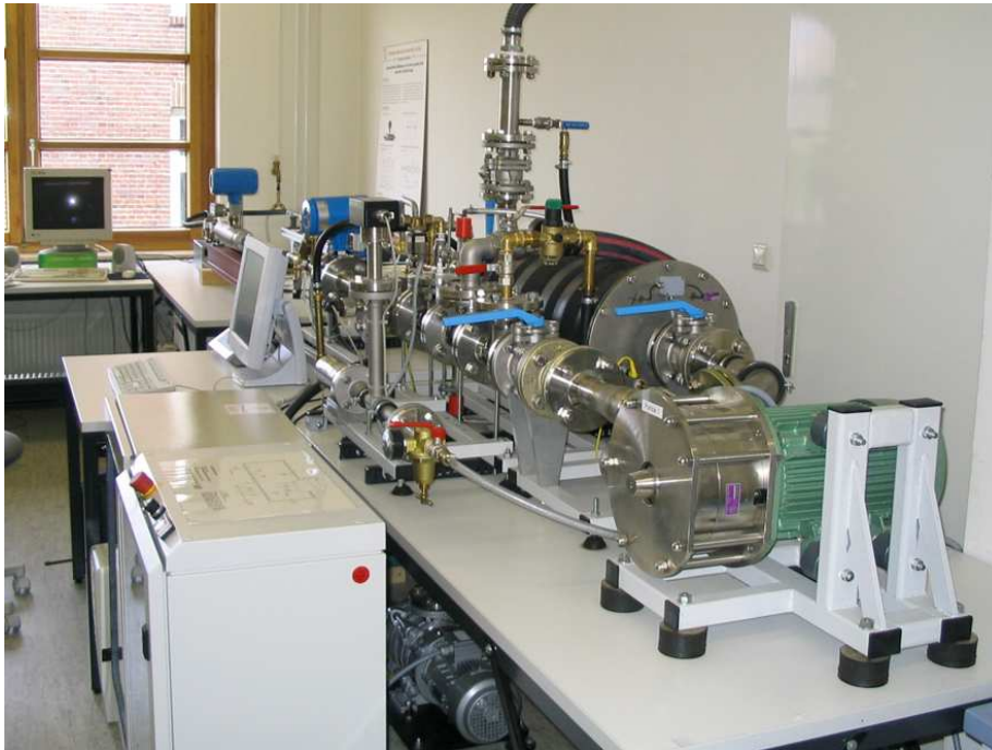
Abb. B.3: Durchflussmessstrecke – gesamte Anlage
