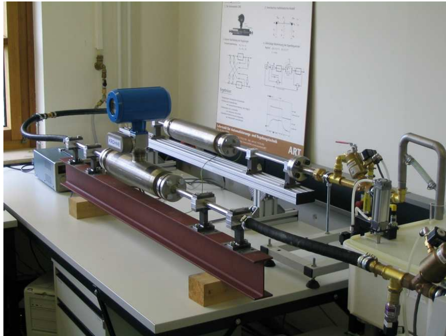
Abb. B.5: Durchflussmessstrecke – linke Hälfte
