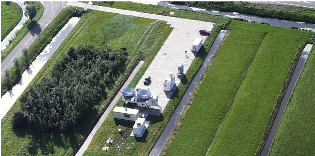
Abbildung 1.3: Die bodengebundenen Wolkenfernerkundungsverfahren auf BBC im August/September 2001 auf dem Experimentalgelände des Niederländischen Wetterdienstes in Cabauw. Neben Wolkenradaren verschiedener Frequenzen, passiver Mikrowelle und einem Lidar das Spektrometer zur Messung der PPL-PDF des IUP Heidelberg im Container rechts oben.
