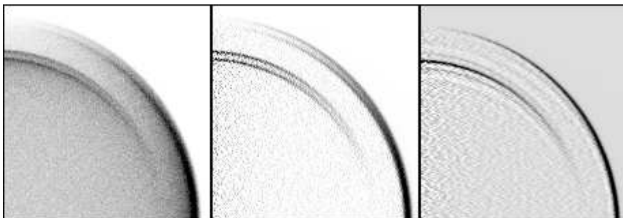
Abbildung 3.20: Darstellung einer möglichen Rekonstruktion einer Geschwindigkeitskarte von H aus HBr unter Berücksichtigung der PSF. Links: Experimentelle Geschwindigkeitskarte. Mitte: Schnitt durch die invers Abel-Transformierte der Rohdaten. Rechts: Entfaltung der 3D-Verteilung mit der PSF [98].
