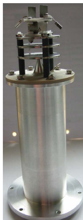
Abbildung 7.12: (Bild links) Aufbau einer Wehnelt-Zylinder- Linsen- Sk2-Kombination für verkürzte Ionen-Flugbahnen im Zwischenvakuum
