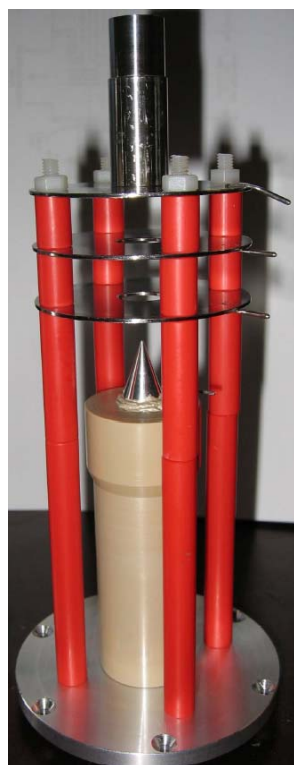
Abbildung 7.12: (Bild links) Aufbau einer Wehnelt-Zylinder- Linsen- Sk2-Kombination für verkürzte Ionen-Flugbahnen im Zwischenvakuum
