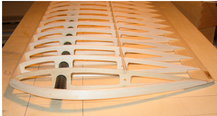
Abbildung 35: Lamellierter Randbogen (eigene Aufnahme)
