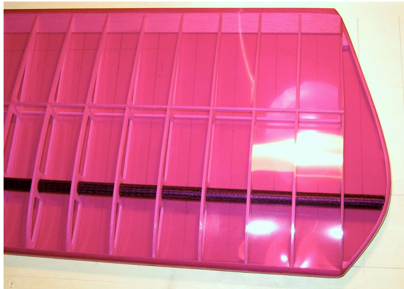
Abbildung 30: Rohrholmbauweise der Tragfläche (eigene Aufnahme)
