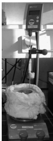
Abb. 2.4.5: Apparatur für die dynamische Synthese mit Heizrührer, Aluminiumblock und Kontaktthermometer.
