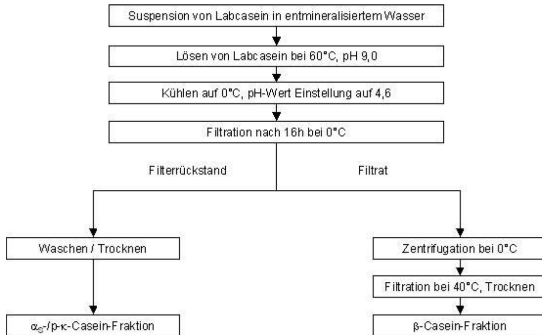
Abb. 18: Verfahrensablauf zur Gewinnung von \beta -Casein einerseits und \alpha_s - und p - \kappa -Casein andererseits im Technikummaßstab.
