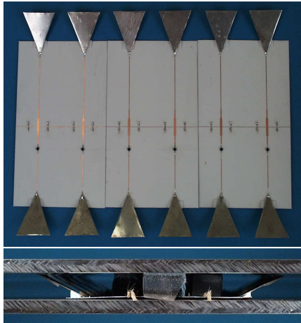
Abbildung 4.12: Der 6-fach-Inlineverstärker in Auf- und Queransicht im PPL
