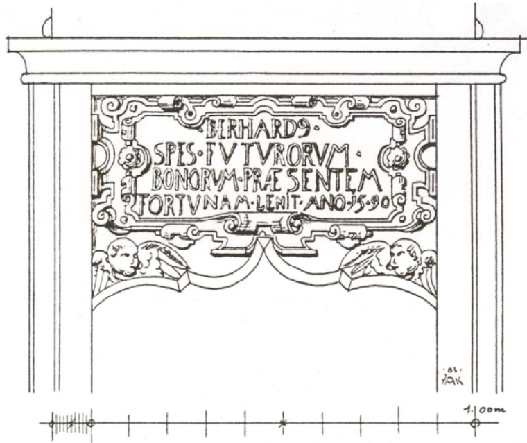
Abb. 159 Sturz, ehem. Hinter der Bardow- wicker Mauer 8, von einem frühe- ren FW-Gebäude, 1590 (i), n.e., Be- schlagwerk und Engelköpfe, Zeichnung Krüger, 1906
