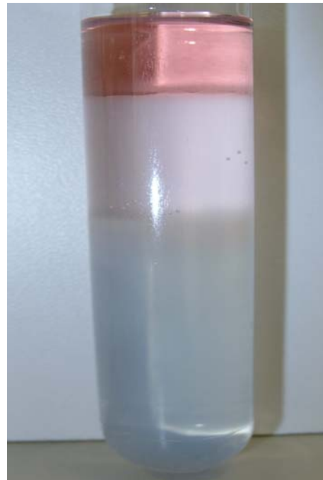
Abb. 3.19: Zerstörung der Gel-Struktur bei Zugabe von 96% Ethanol
