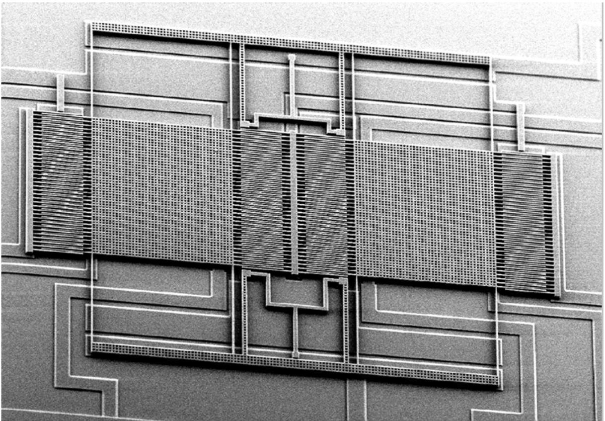
Abbildung 3.47: REM-Foto des oberflächenmikromechanischen Drehratensensors
