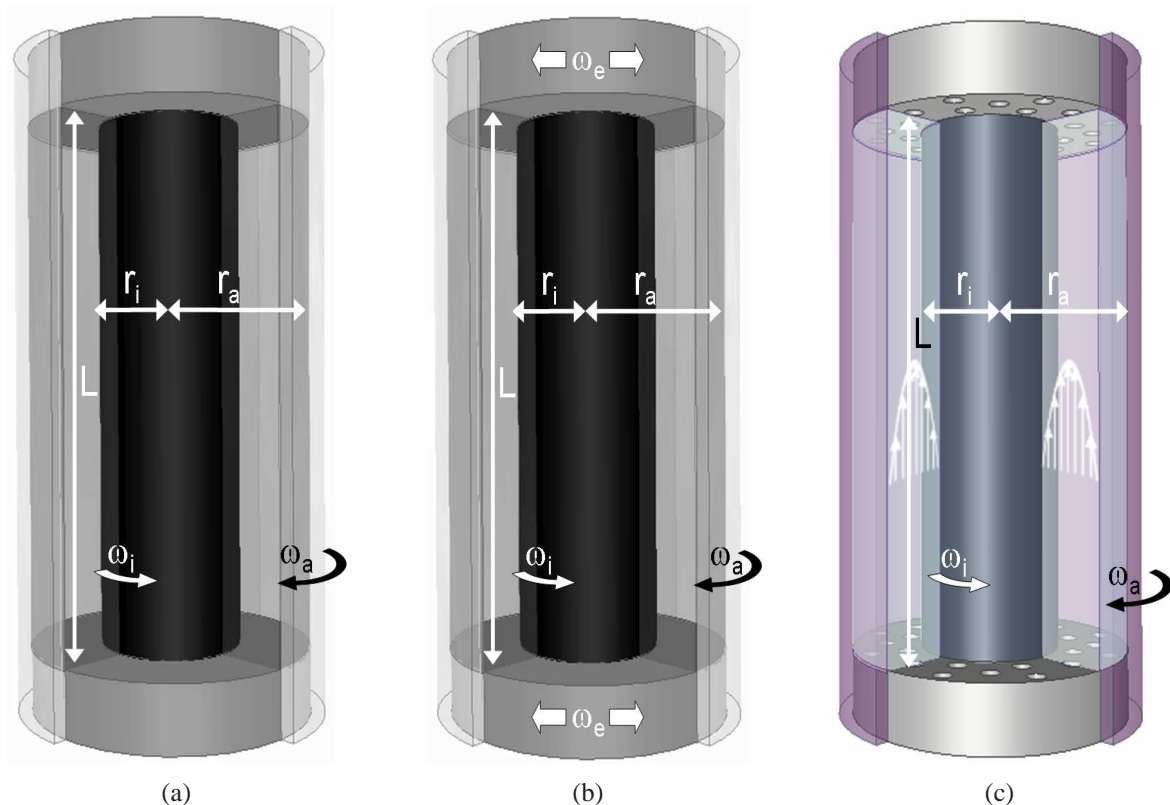
Abbildung 2.1: Schematische Darstellung eines Taylor-Couette-Systems mit rotierenden Zylindern (a), mit rotierenden Deckelplatten (b) und mit zusätzlichem axialen Durchfluss (c).
