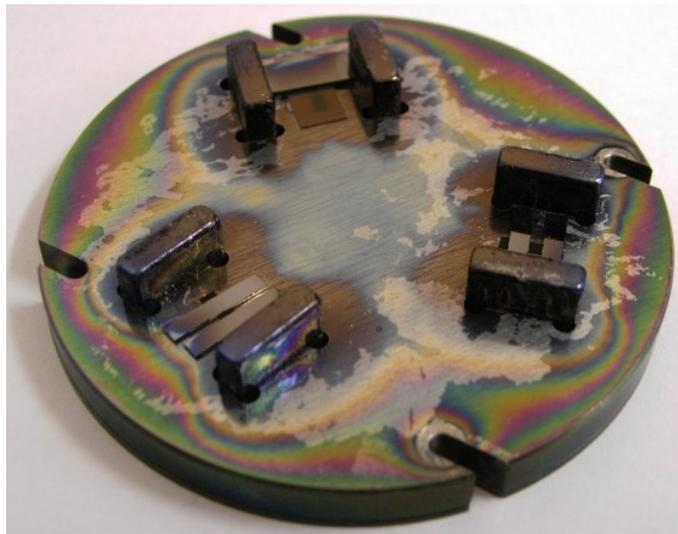
**Abbildung 5.19:** Fotografie des Probenhalters, bei dem mittels Permanentmagnete ein externes Magnetfeld in Filmebene angelegt wird. Durch die Stärke des Magnetfelds verändert sich die Verteilung der Abscheideraten auf dem Probenhalter, was deutlich an den Interferenzstreifen zu erkennen ist.
