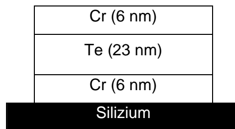
Abb. 57: Schematischer Aufbau des Mehrschichtsystems Cr/Te/Cr
