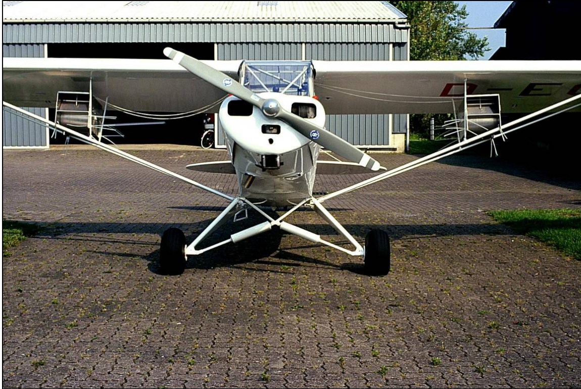
Abb. 6 Frontansicht der PA18. Position der APS außerhalb des Propellerstromes. (Foto: H.Weidel)
