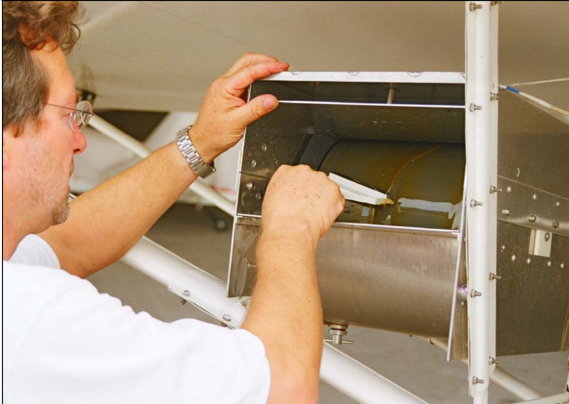
Abb. 8 Aufbringen des Haftmittels auf die Haftmitteltrommel kurz vor dem Start. (Foto: Dr. V. Arnold)
