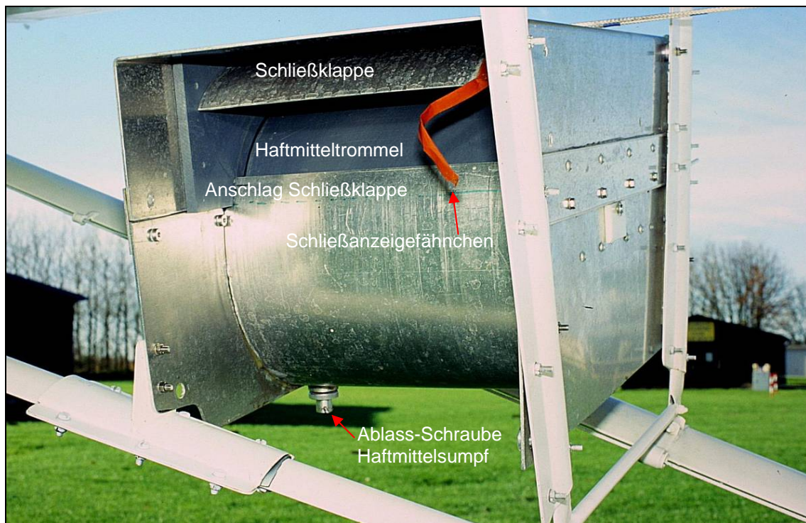
Abb. 5 Luftaustrittsöffnung mit geöffneter Schließklappe und Schließanzeigefähnchen. (Foto: H. Weidel)
