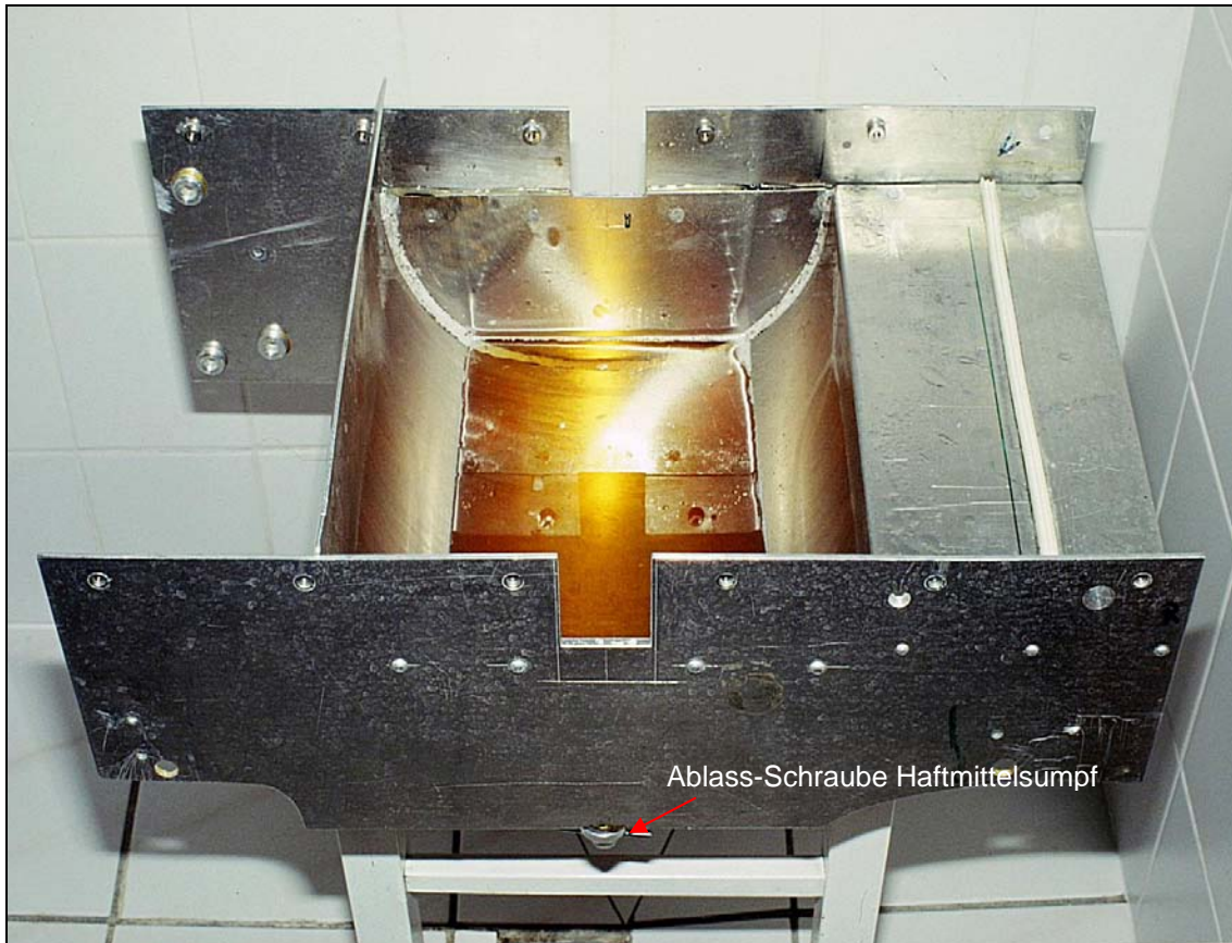
Abb. 11 Geöffneter Aeroplanktonsammler. Unterschale ohne Haftmitteltrommel u. ohne Elektromotor mit Glukoselösung zur Bergung des Fanggutes. (Foto: H.Weidel)
