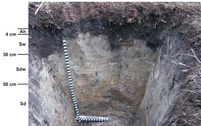
Abb. 4.5: Profil des Pseudogleys des Forststandortes in Rotthalmünster, Grabung April 2005 (Foto: Jens Habermann)
