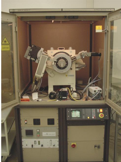
*Abb. 4.4: XRD 3000 Zweikreisdiffraktometer von Seifert*
