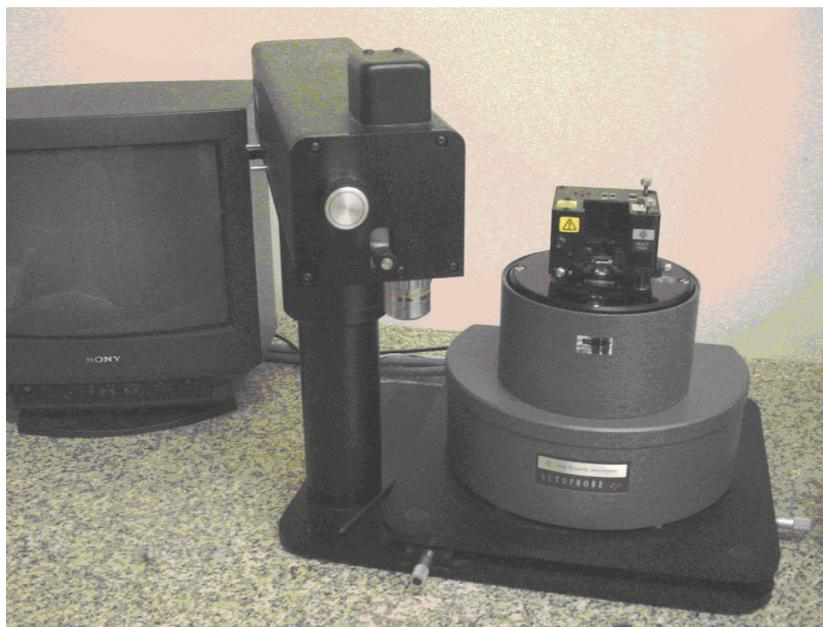
*Abb. 4.3: Autoprobe cp-AFM von Park Scientific Instruments*
