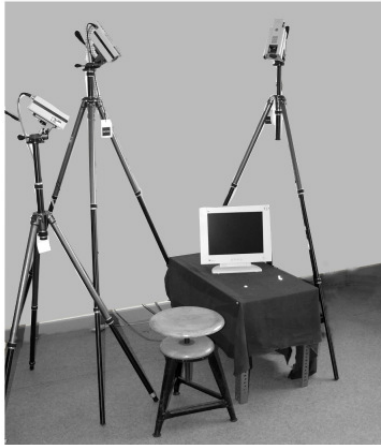
a) Aufbau zur Messung von Greifbewegungen
