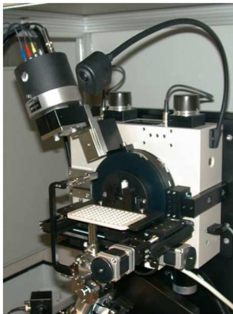
Abbildung 3.5 Hochdurchsatz-Pulverdiffraktometer der Firma STOE.
