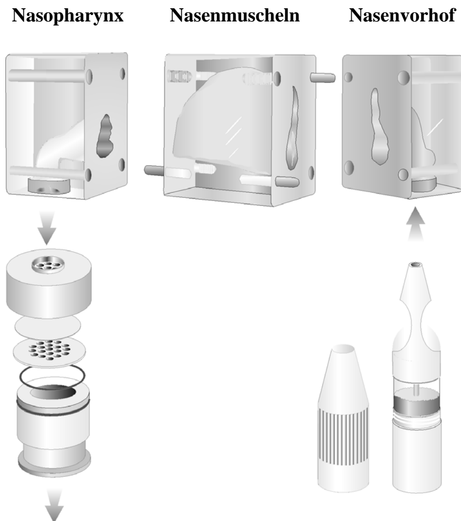
Abb. 8.1 Schematische Darstellung des Versuchsaufbaus zur Bestimmung der In-vitro-Deposition von Apomorphin HCl
