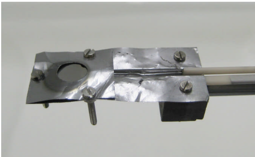
Abbildung 4-2: Photo des Probenhalters der Diffusionsanlage mit montierter Probe.
