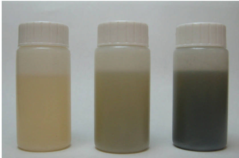
Abbildung 4-16: LSC-Gefäße (Vials) gefüllt mit dem Szintillation-Cocktail.
