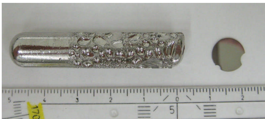
Abbildung 3-3: Photo eines Probenstabes der Legierungszusammensetzung Pd_{43}Cu_{27}Ni_{10}P_{20} und einer Probenscheibe zur Diffusionsuntersuchung.
