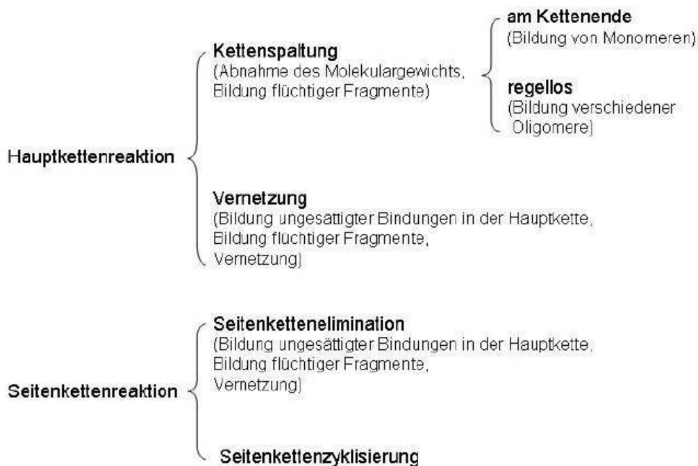
Abbildung 3.6 Übersicht der chemischen Prozesse, welche während des thermischen Abbaus von Polymeren auftreten können [nach Beyler1995]
