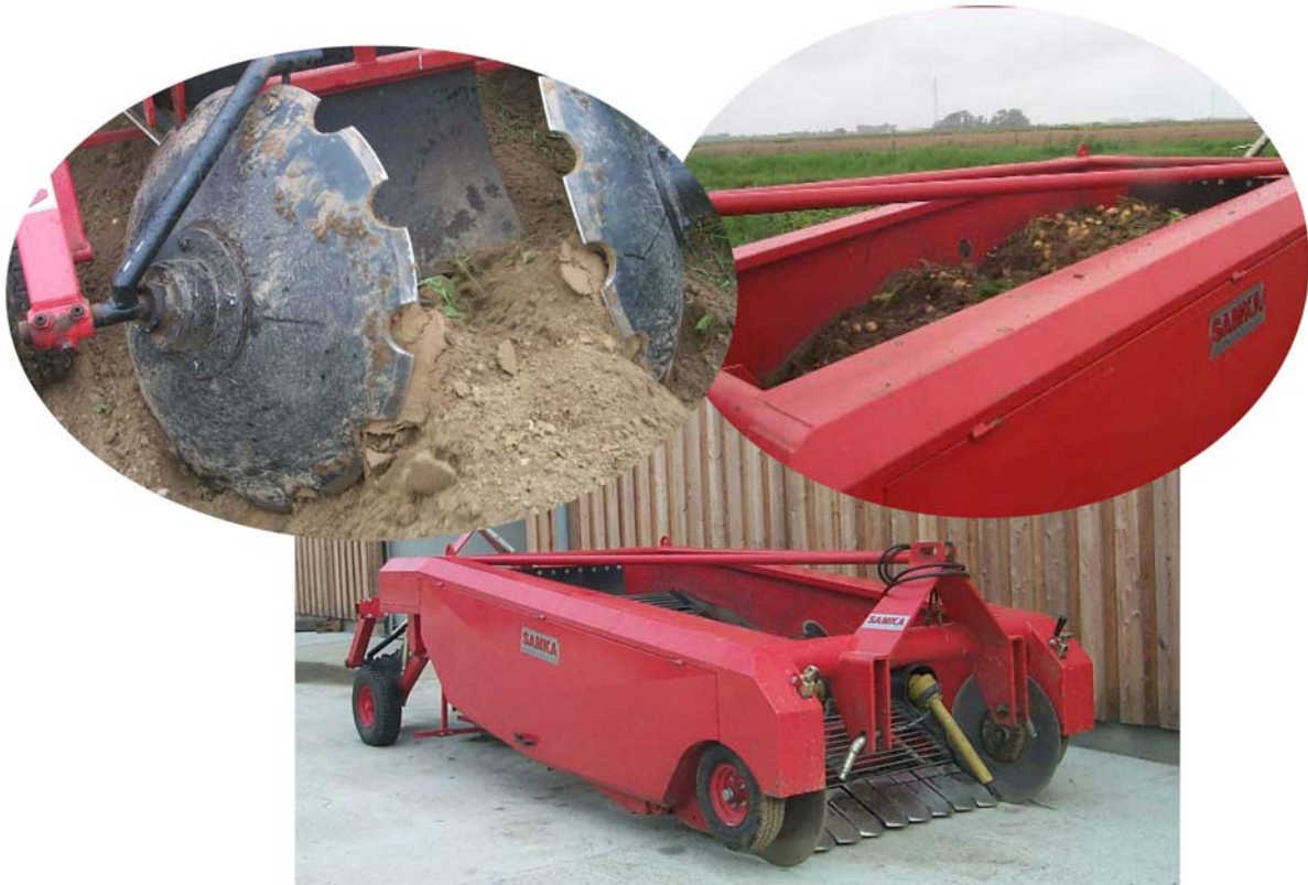
Abb. 2: Samka GCL, zum kombinierten Roden und Zudecken
