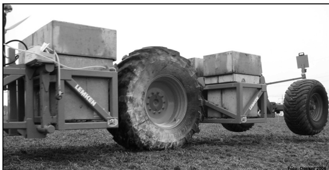
Abbildung 3: Der Lastrahmen MOVIS mit Betonregistergewichten im Trägerrahmen
