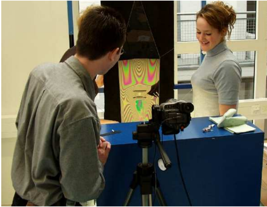
Abb. 5.1: Am Seifenfilmkanal des DLR_School_Labs Göttingen lässt sich das Strömungsverhalten um Flügelprofile und andere Modellkörper untersuchen.
