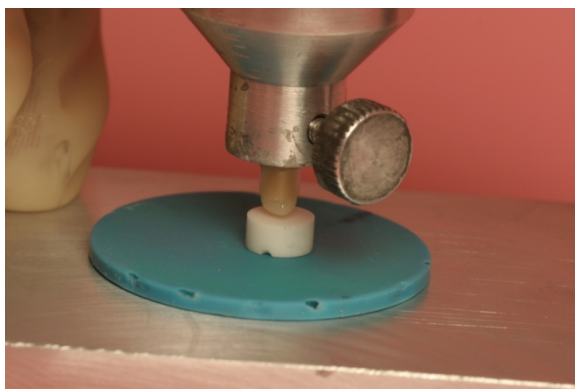
Abbildung 6: Verkleben einer Probe
