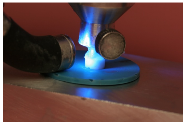
Abbildung 7: Lichthärtung einer Probe
