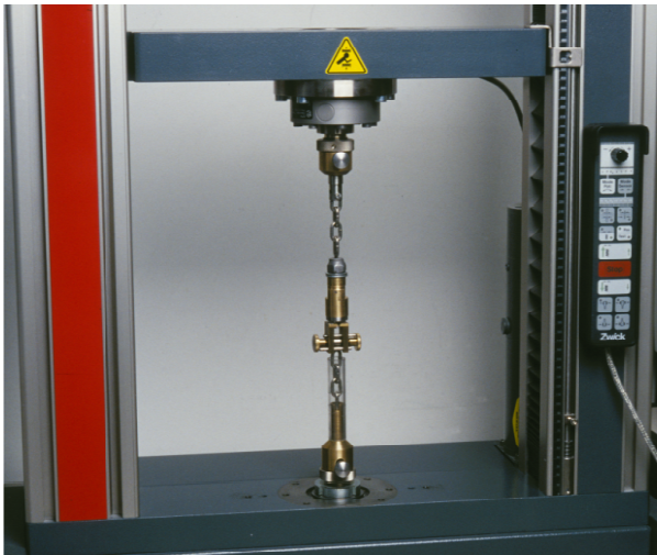
Abbildung 9: Darstellung der Universalprüfmaschine mit einer für den Abzugstest fixierten Probe
