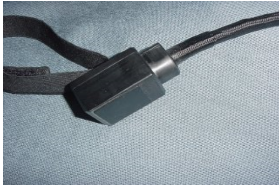
Abb.3: Thermode der Firma Medoc (Israel) zur Erhebung thermischer Schwellen
