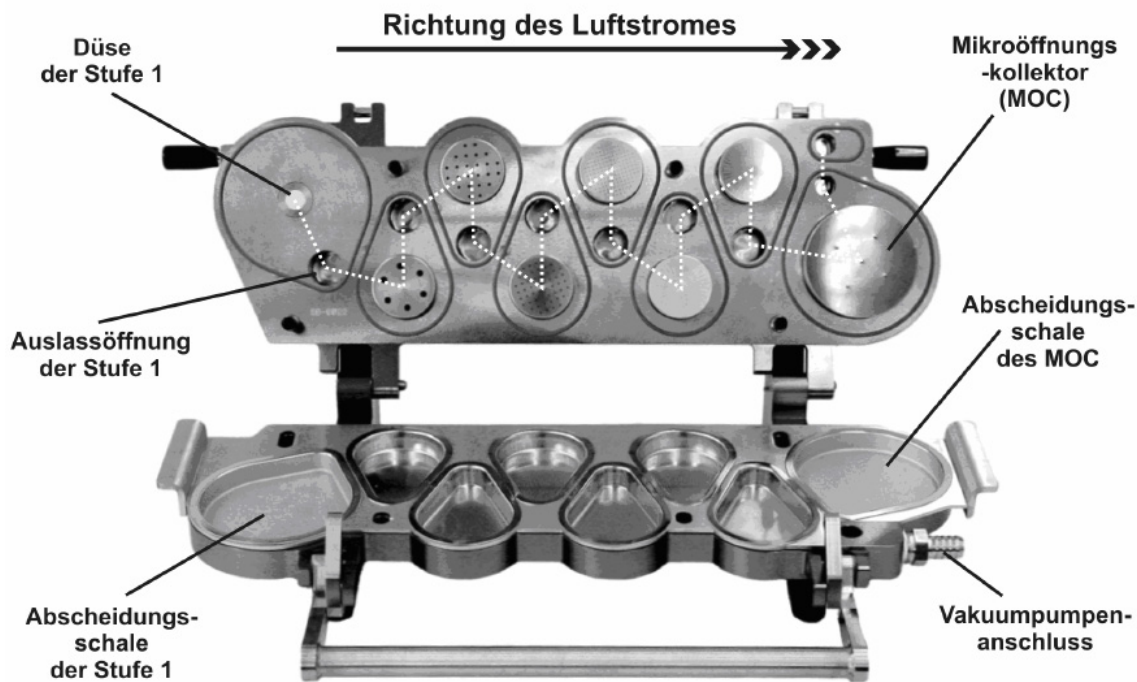
Abbildung 2.12: Next Generation Pharmaceutical Impactor (NGI), geöffnet
