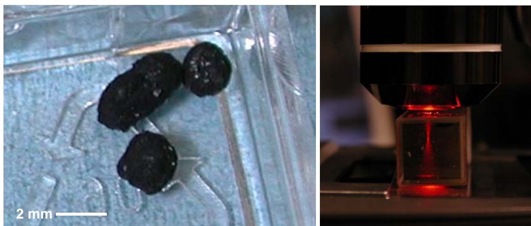
Abbildung 31: Links: Nicht vorgereinigte HiPCO-Nanotubes in ihrer typischen, flockigen Kugelform. Rechts die Dispersion der HiPCO-Tubes in \text{AsCl}_3 unter dem LabRam-Spektroskop. Deutlich erkennbar sind der Tyndallkegel und der Fokuspunkt des Anregungs-LASERs.
