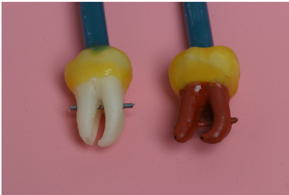
Abbildung 2.2: Schutz vor Austrocknung (Tauchwachs) und Rotation (Stahldraht) vor und nach Aufbringung des künstlichen Parodonts
