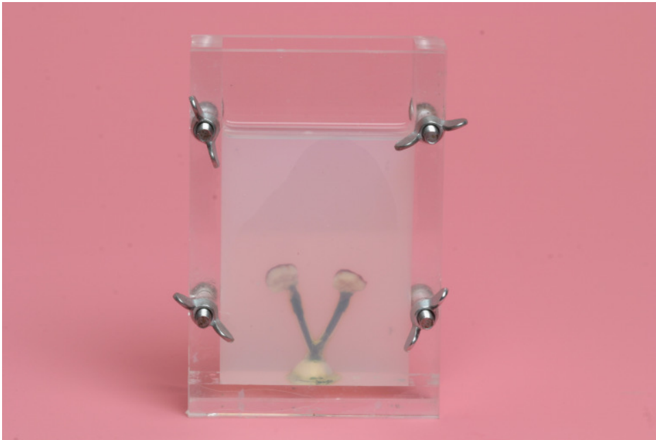
Abbildung 2.8: Modellationsvorlage für Herstellung der 64 Kauflächen nach Aushärtung des Silikons
