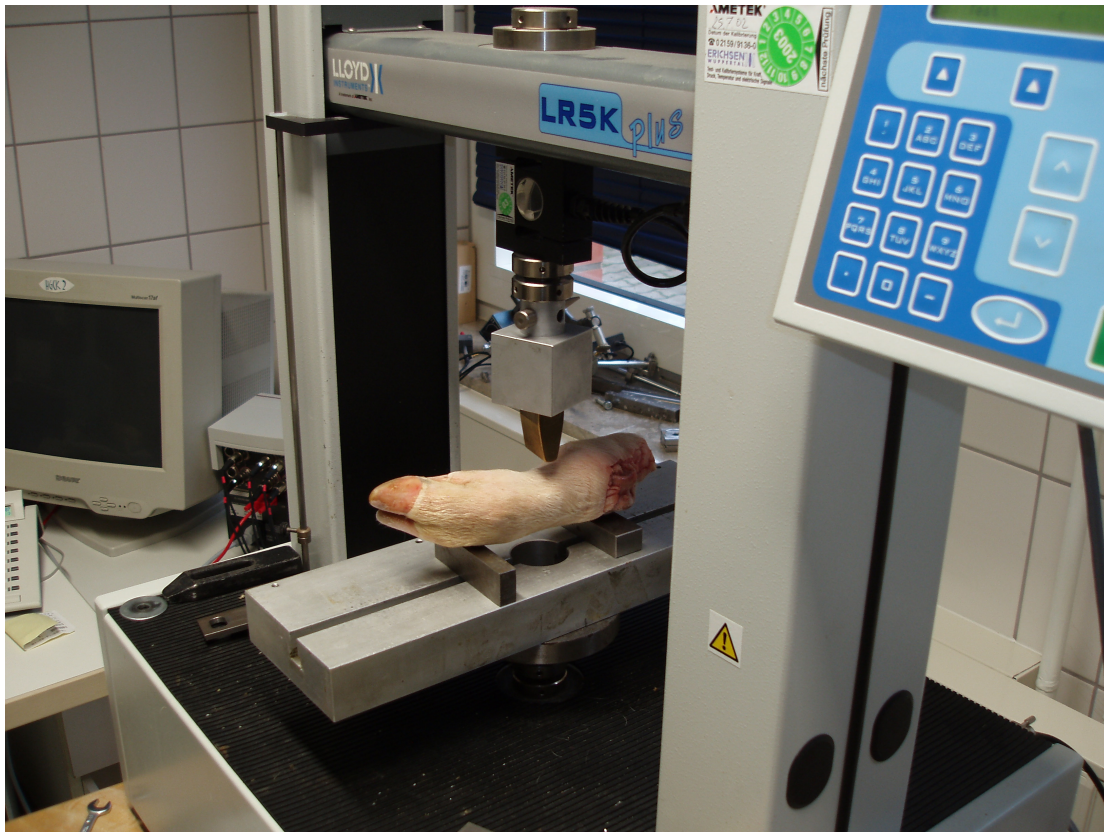
Abb 3: Versuchsaufbau: Frakturierung einer Schweinepfote mittels Materialprüfmaschine (Lloyd Instruments LR5Kplus®, Fareham, Großbritannien)
