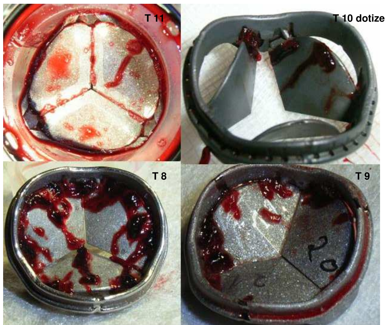
Abb.17: Darstellung der Ergebnisse der 1. Versuchsreihe. In der ersten Versuchsreihe verfügte die Ti-Beschichtung (T 8), die durch manuelle Polierung behandelt wurde, über massive thrombotische Ablagerungen. Im Vergleich dazu besaß die Ti- Klappe, die unbehandelt ins Flußmodell eingesetzt wurde, deutlich geringere Gerinnsel. Von den unbehandelten Ti- Oberflächen wurden die Klappen T 11 und T 9 getestet, wobei die T 11 weniger thrombosiert war. Die Oxidbeschichtung bei T 10 dotize zeigte trotz einer glätteren Beschaffenheit ebenfalls Ablagerungen sowohl im Scharnierbereich als auch im Bereich der Klappensegel.
