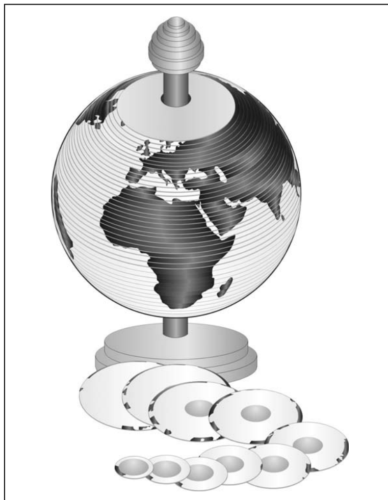
Abbildung 3.1: Prinzip des Schichtbauverfahrens am Beispiel eines Schichtenpuzzles
