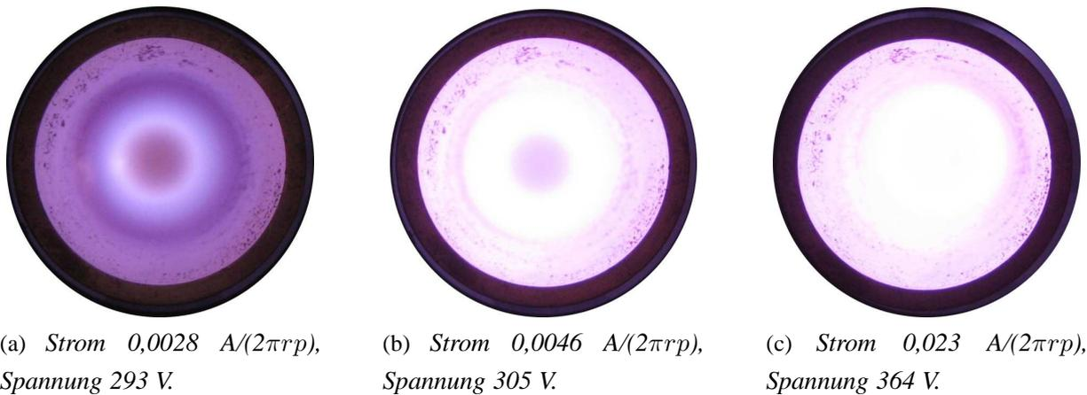
Abbildung 5.3: Fotografische Darstellungen der Hohlkathodenglimmentladung bei verschiedenen reduzierten Entladungsströmen und den entsprechenden Spannungen bei einem Druck von  $50 \text{ Pa}$ .
