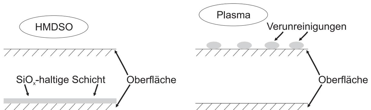
(a) Prozesse bei der Plasmapolymersation: Bildung dünner Schichten auf der Oberfläche mittels Polymerisation von Monomeren.
