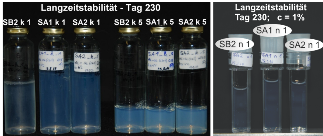
Abbildung 9.5: Visualisierung der Langzeitstabilität (230 Tage) der untersuchten MM-Systeme (links: Lagerung bei 5°C c = 1 und 5%; rechts: Lagerung bei RT, c = 1\% , Proben in verschließbaren Küvetten)
