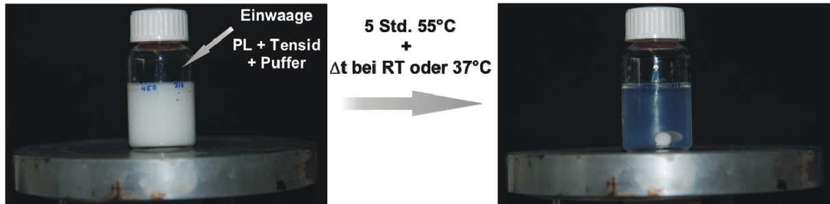
Abbildung 3.17: Schematische Darstellung der direkten Dispergierung (dD)
