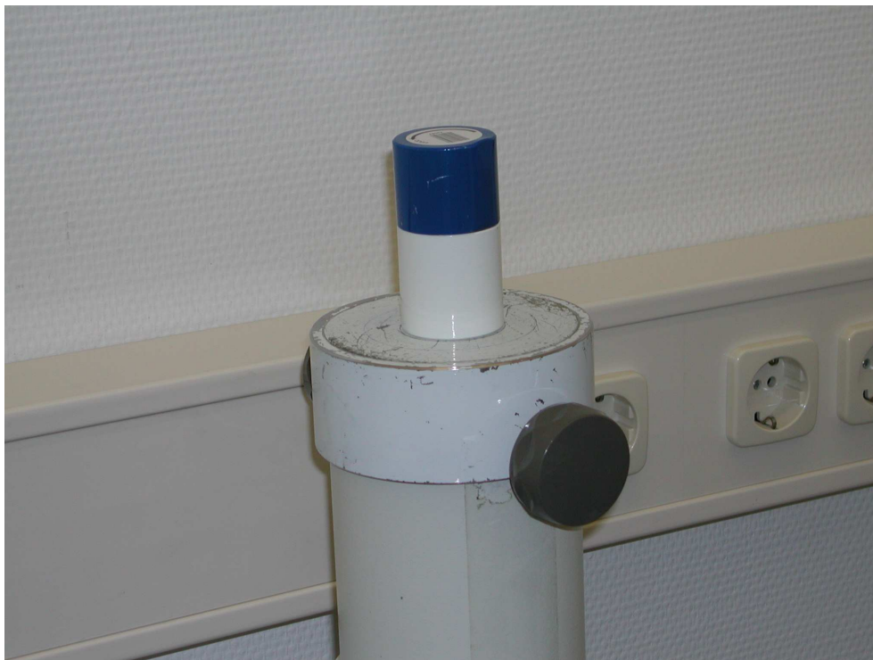
Abbildung 11: GröÙe I der Transportbleiabschirmung bei der Messung an der Uptake-Messsonde
