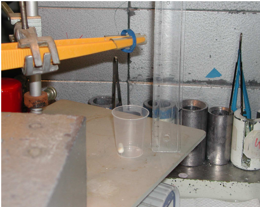
Abbildung 7: Prinzip der Messung der Ortsdosisleistung in 10 cm Entfernung ohne Abschirmung der radioaktiven Kapsel
