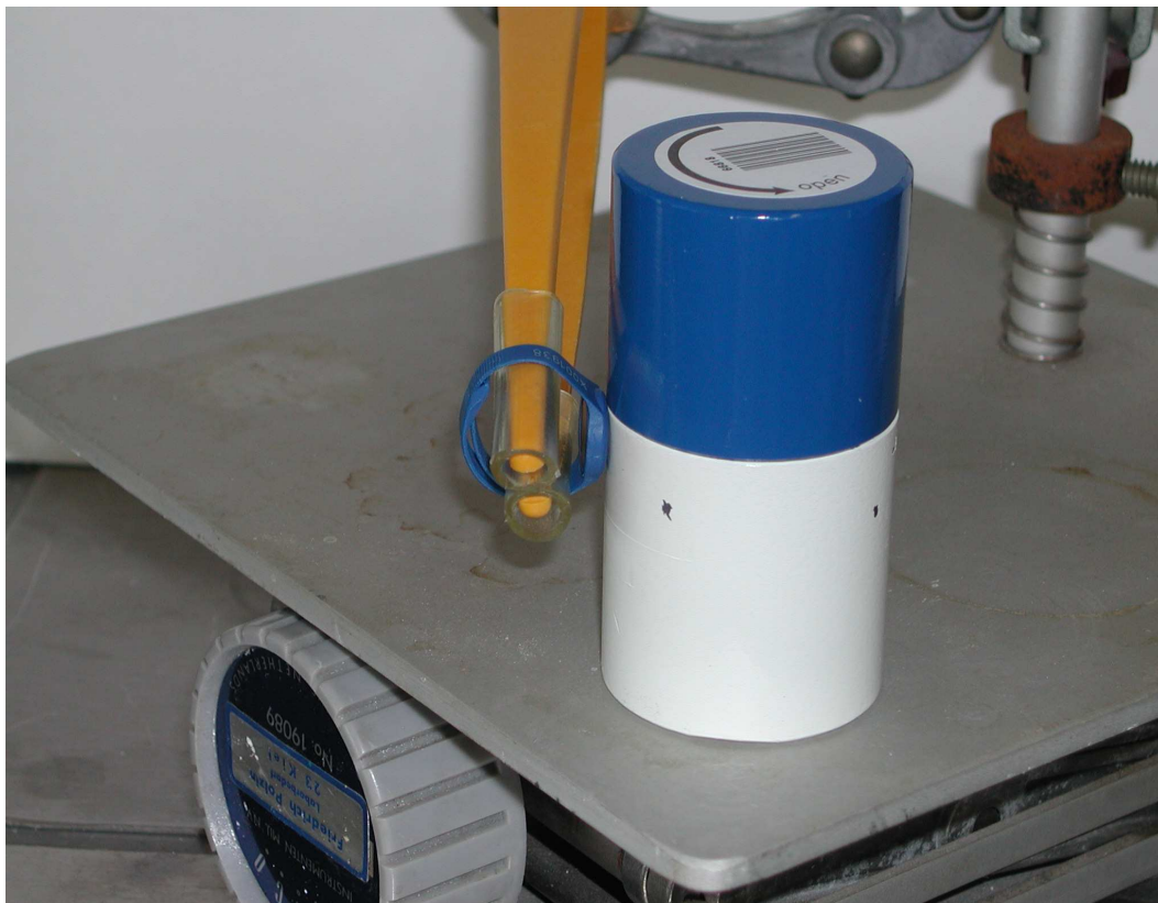
Abbildung 6: Prinzip der Messung der Ortsdosisleistung an der Seite eines Vorgängermodells der Transportbleiabschirmungen
