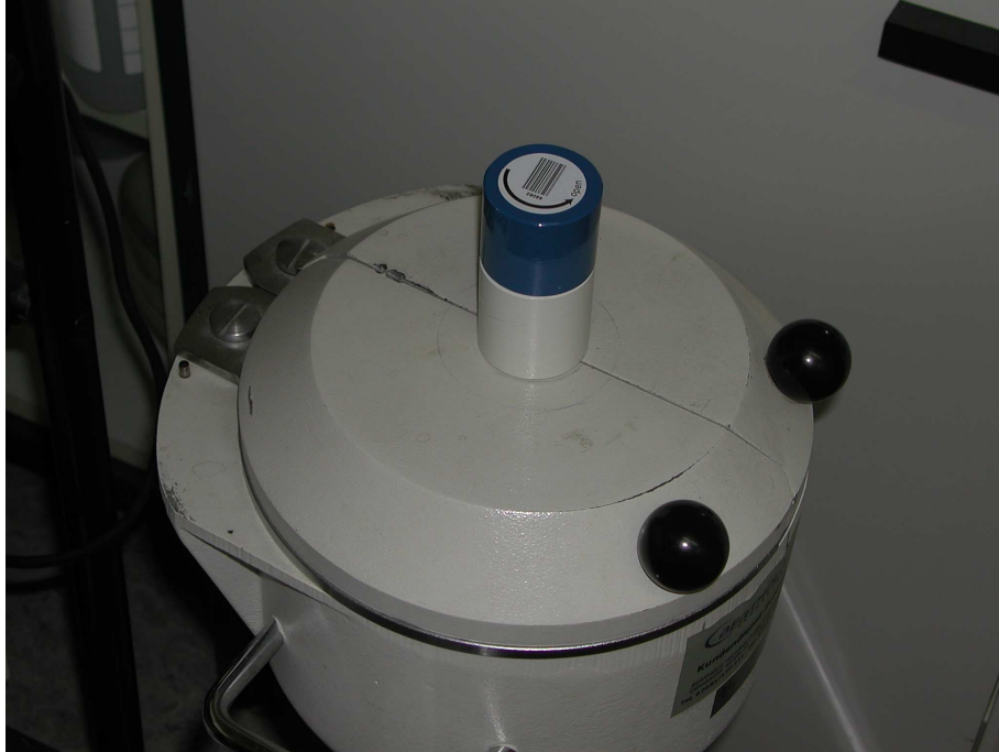
Abbildung 10: GröÙe I der Transportbleiabschirmung bei der Messung am Bohrlochmessplatz
