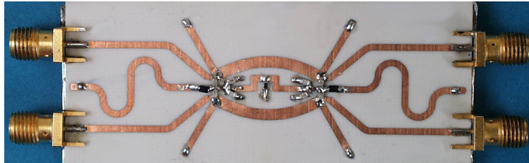
Bild 8.4: Aufgebauter Branch-Line Koppler (Hybrid-Technik).
