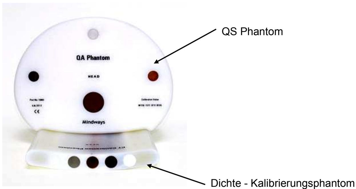
Abb.3: QS Phantom mit einem unterliegenden Typ 3 Patientenphantom zur Durchführung der Qualitätssicherungsmessung. Mit freundlicher Genehmigung der Fa. Mindways, Austin, TX, USA.
