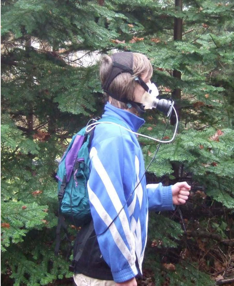
Abb. 5: Ein Proband während eines Probeversuchs. Zu sehen ist die Gesichts-Atemmaske mit aufgesetztem Volumensensor sowie Gasschlauch und Kabel, welche die Verbindung zu dem MetaMax®-Gerät herstellen. Das Gerät wird im Rucksack auf dem Rücken des Probanden getragen. In der linken Hand trägt der Probanden den Druckschalter zur Ereignismarkierung.
