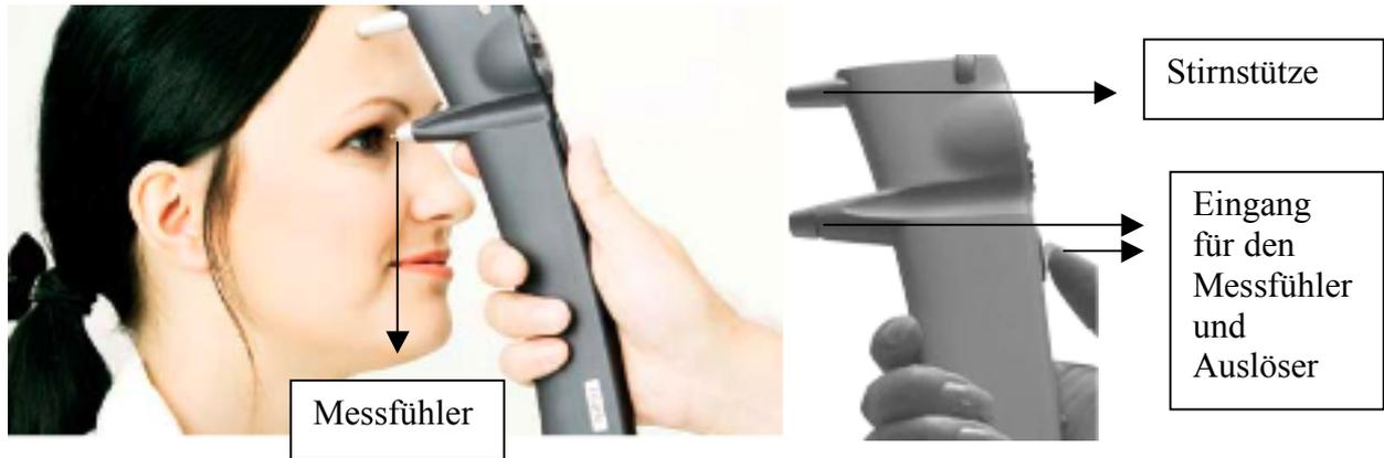
**Abbildung 5: Das iCare Tonometer**
