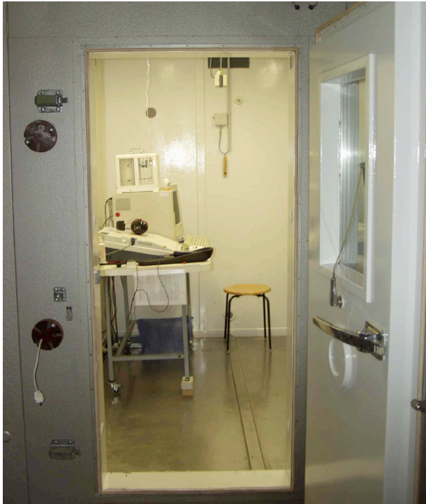
Abb. 1: Messanordnung in der Klimakammer; man blickt durch die offene Tür der Kammer. Zu sehen ist der Tisch mit dem Thermostest-Gerät und dem Messcomputer.
