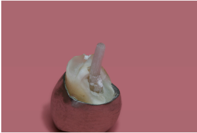
Abbildung 3.3: Frakturverlauf in Gruppen W3 und W2
