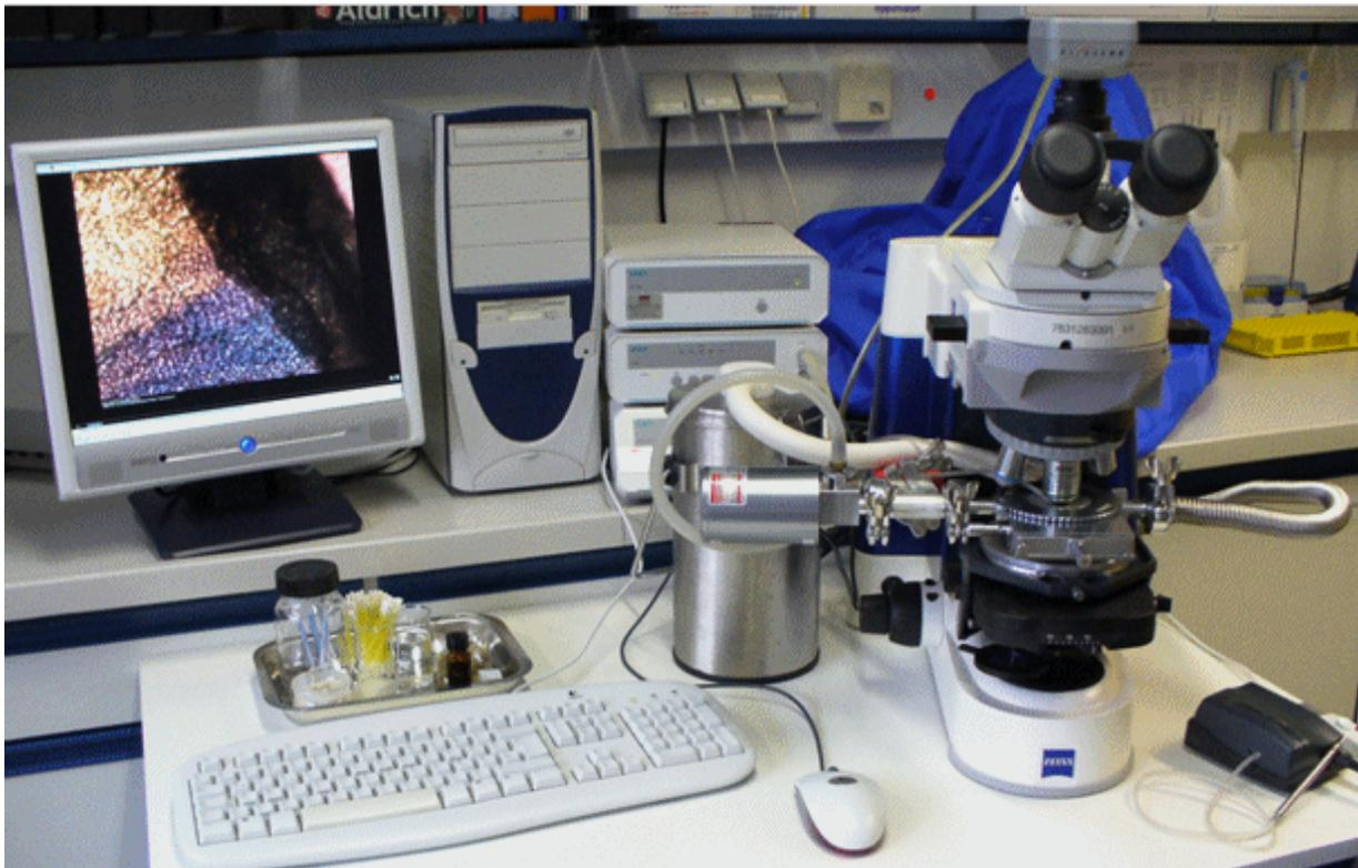
Abbildung 3.8: Gefriertrocknungsmikroskop ([www.freeze-drying.eu](http://www.freeze-drying.eu))
