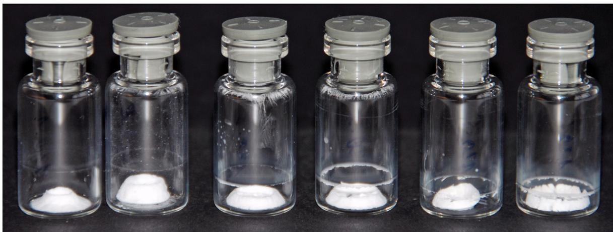
*Abbildung 5.17: Aufnahmen der untersuchten Formulierungen, sortiert nach aufsteigender Feststoffkonzentration: oben langsam eingefroren, unten schnell eingefroren*
