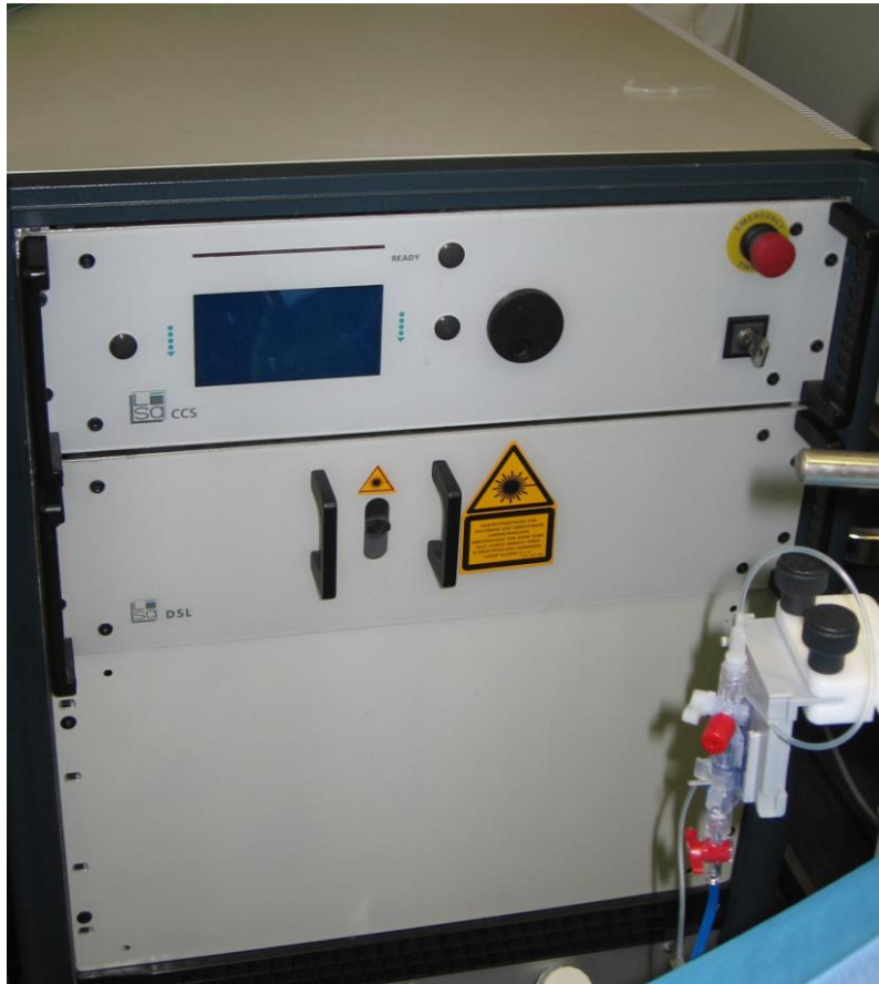
Abb. 2-9: Hauptgerät des Thulium-YAG-Lasers
