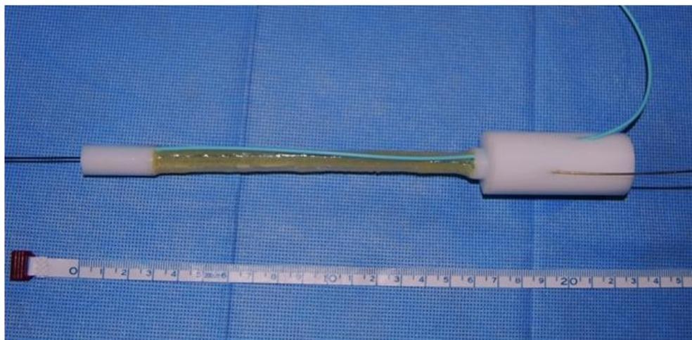
**Abb. 58: Inlay des Prototypen VII mit einem Draht zur Demonstration des Optik-Kanals.**
