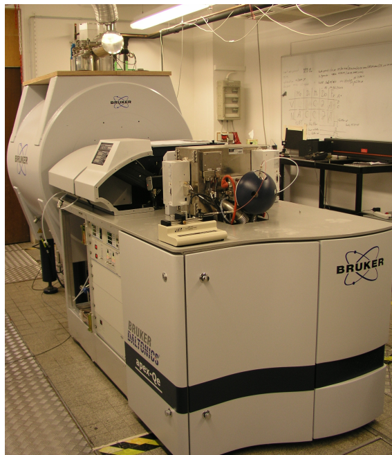
Abbildung 3.1. – Blick auf das genutzte FT-ICR Massenspektrometer APEX Qe von der Anwenderseite: Vor dem Magneten ist der Vakuumbwagen mit dem UHV-Einlasssystem, den Kontrollanzeigen und der Ionenquelle zu erkennen.
